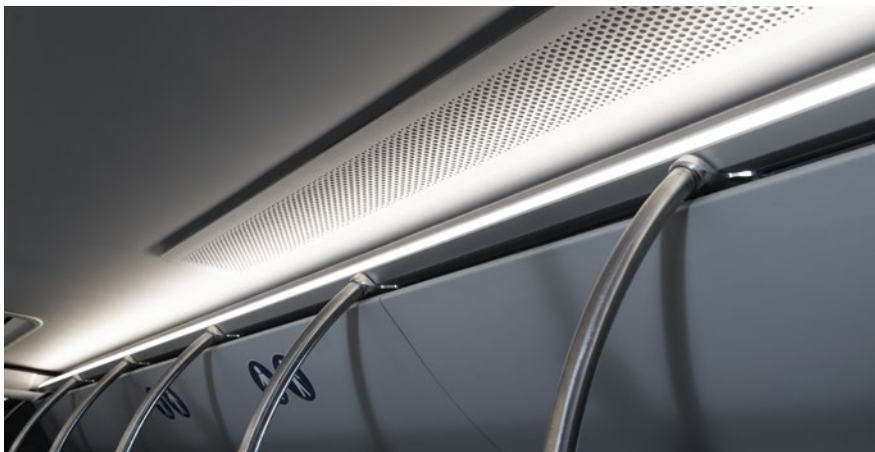
Indirekte LED-Beleuchtung im Fahrgastraum
