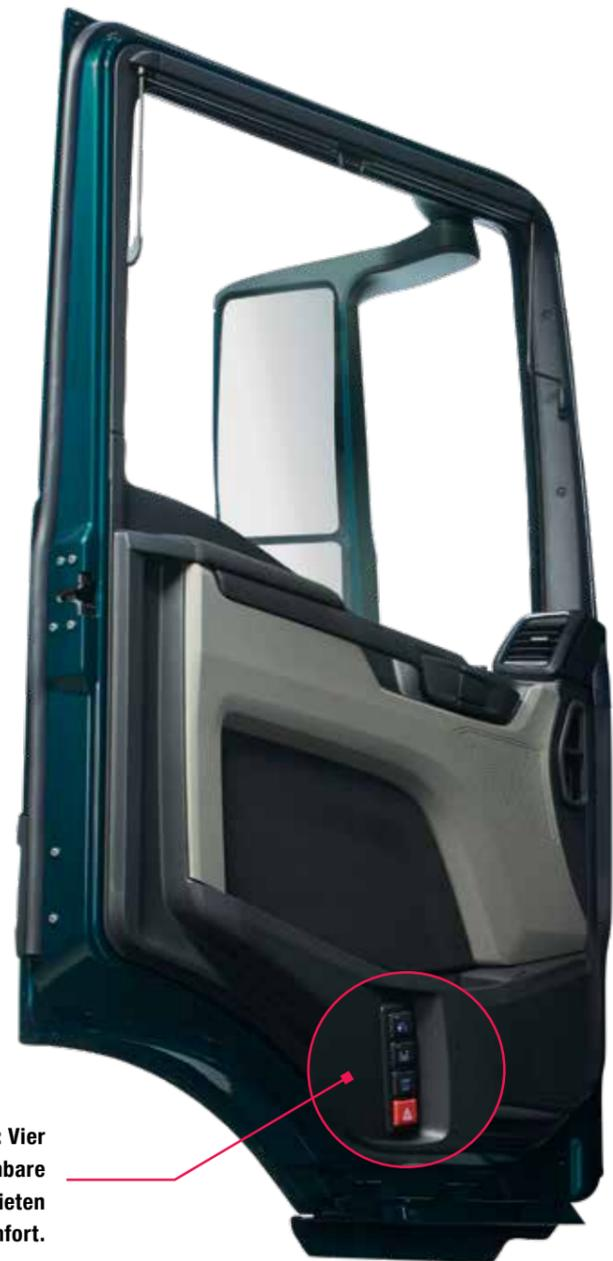
**MAN EasyControl: Vier von außen erreichbare Bedientasten bieten maximalen Komfort.**
