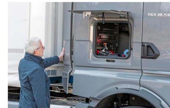
Beide Sideflaps lassen sich an die Rückwand klappen. Die Türen der geräumigen Außenstaufläche (je rund 200 Liter) öffnen nach oben. Zusätzliche untere Staufächer gibt es beim mittelhoch montierten TGX-Haus nicht, dafür bleibt der Einstieg vergleichsweise niedrig.
